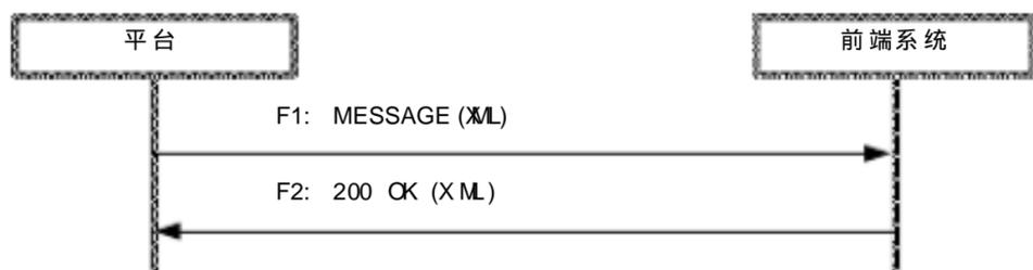
图 B.5 录像检索接口流程
