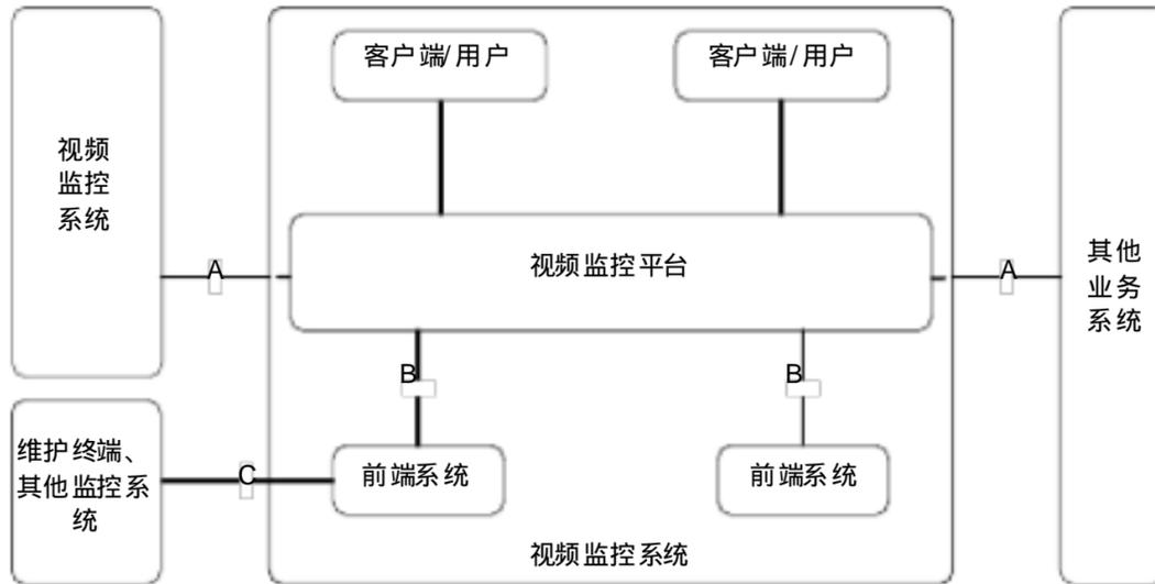
图 3 系统中接口参考点示意图
