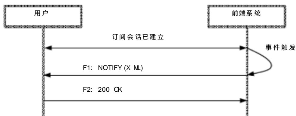
图 C.12 事件通知接口流程
