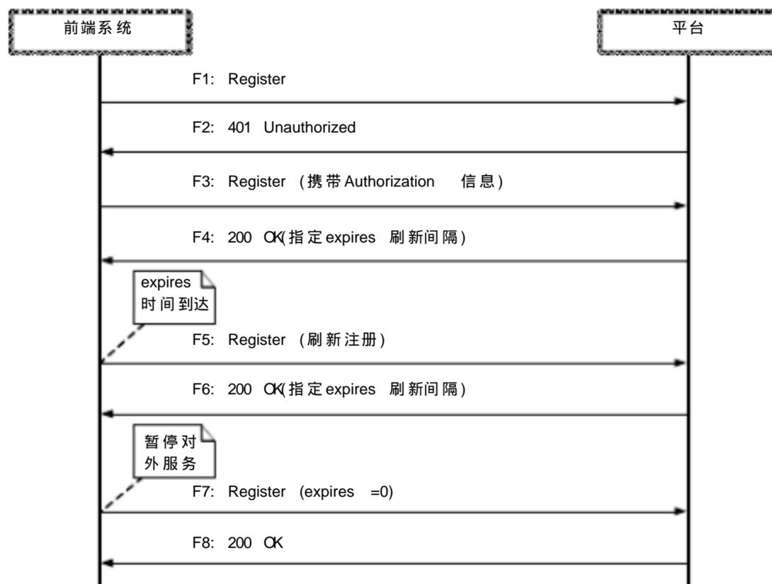
图 B.1 注册接口流程
