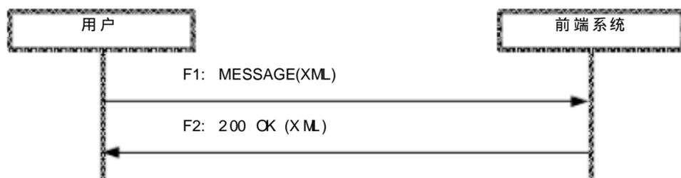
图 C.6 录像检索接口流程
