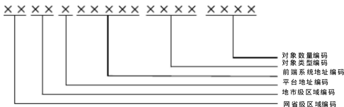
图 D.1 对象地址编码结构
