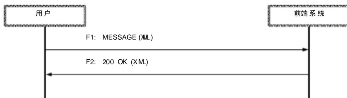
图 C.4 设备工作状态获取接口流程
