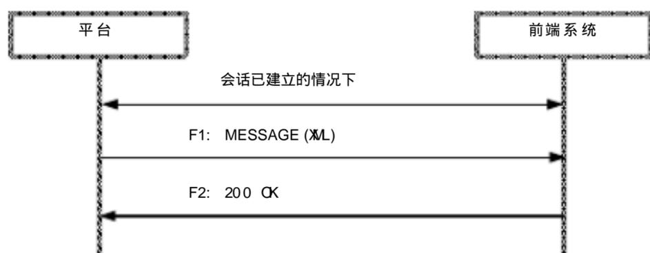
图 B.8 云镜控制接口流程
