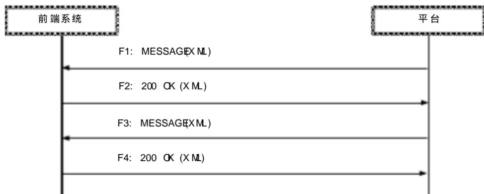
图 B.3 资源信息获取接口流程
