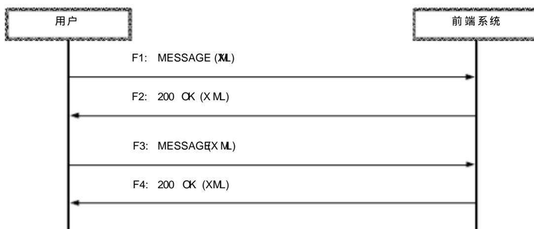
图 C.17 视频参数获取及配置流程
