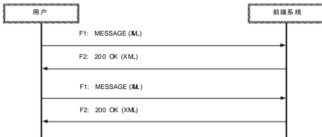
图 C.24 设备时间获取及配置接口流程
