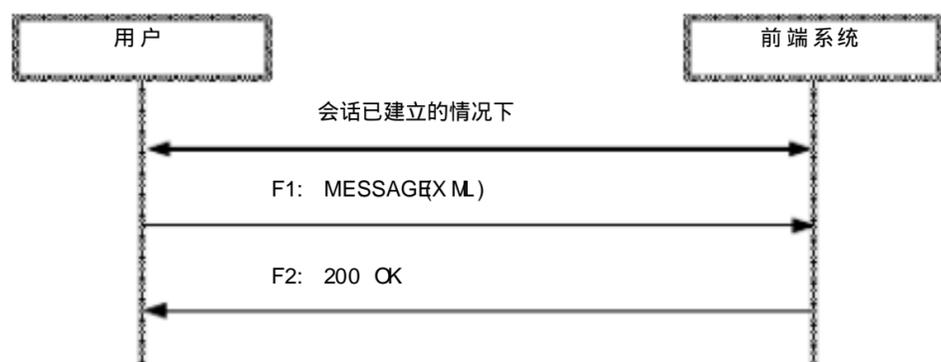
图 C.9 云镜控制接口流程
