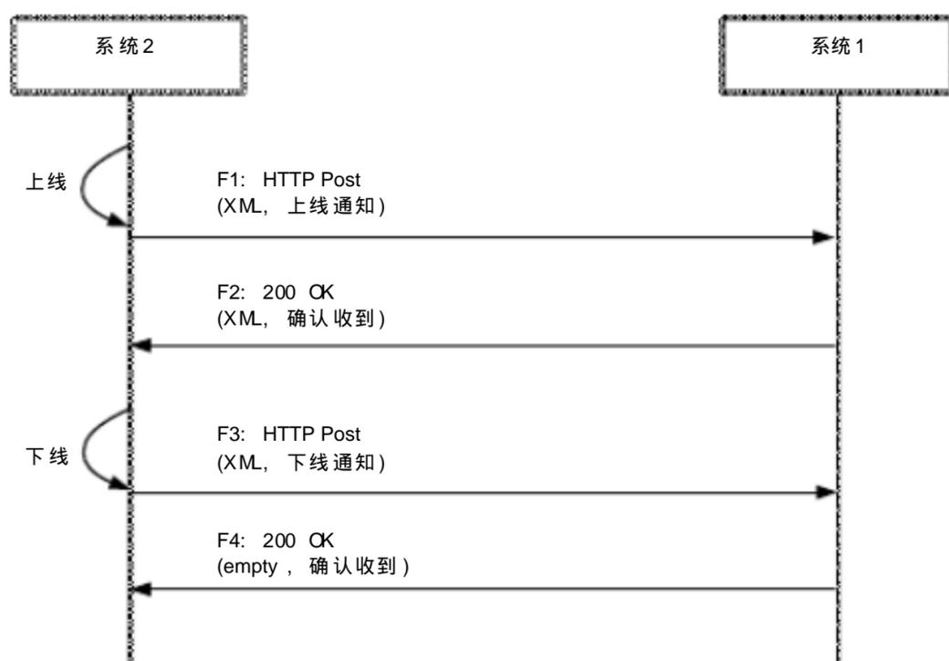
图 A.1 系统上下线通知流程
