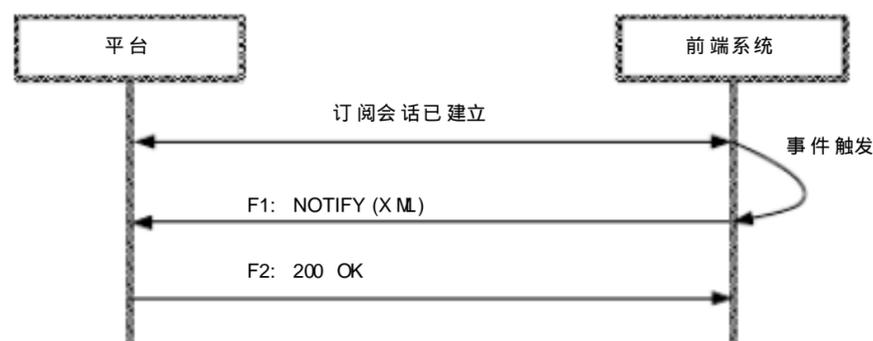
图 B.10 事件通知接口流程
