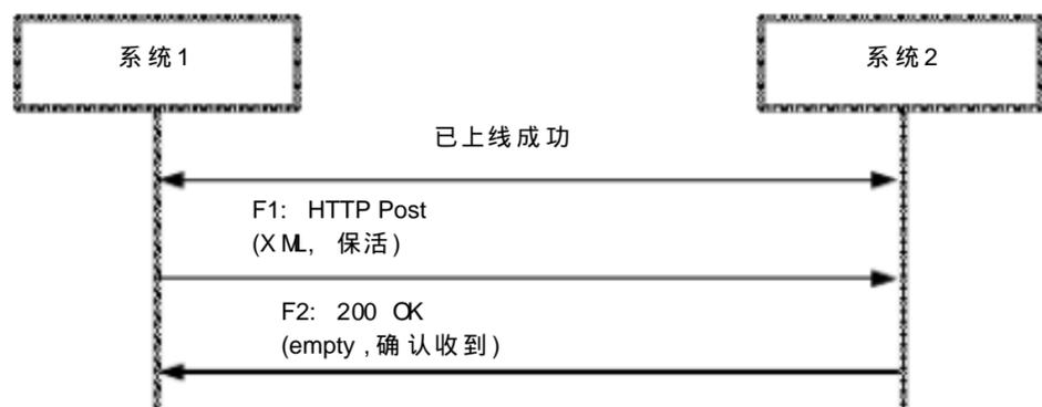
图 A.2 系统心跳通知流程
