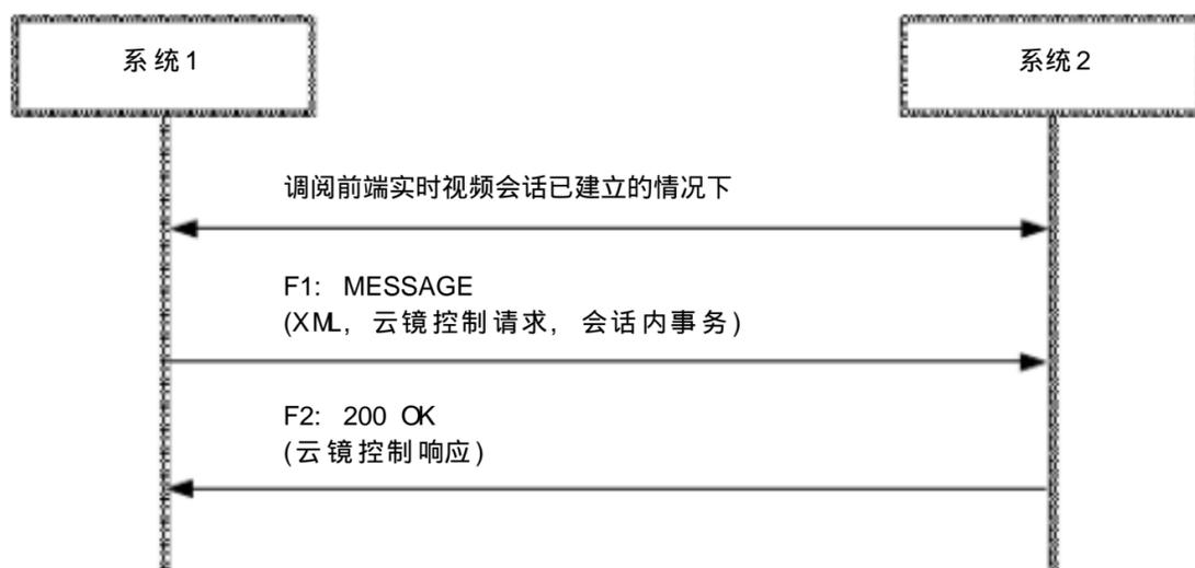
图 A.10 云镜控制接口流程
