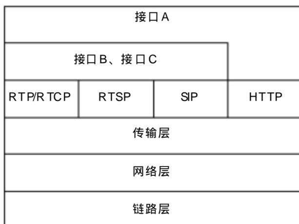
图 4 接口协议结构图
