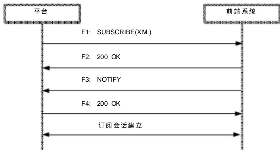
图 B.9 事件订阅流程
