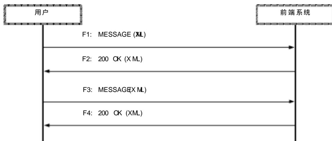
图 C.19 OSD 参数获取及配置流程
