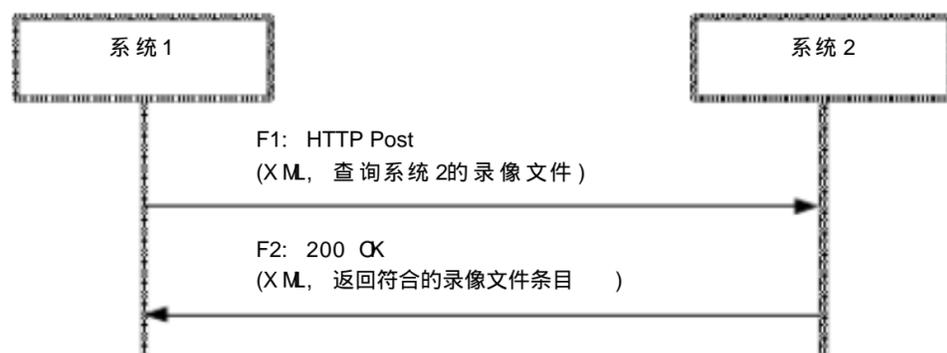
图 A.5 录像检索接口流程
