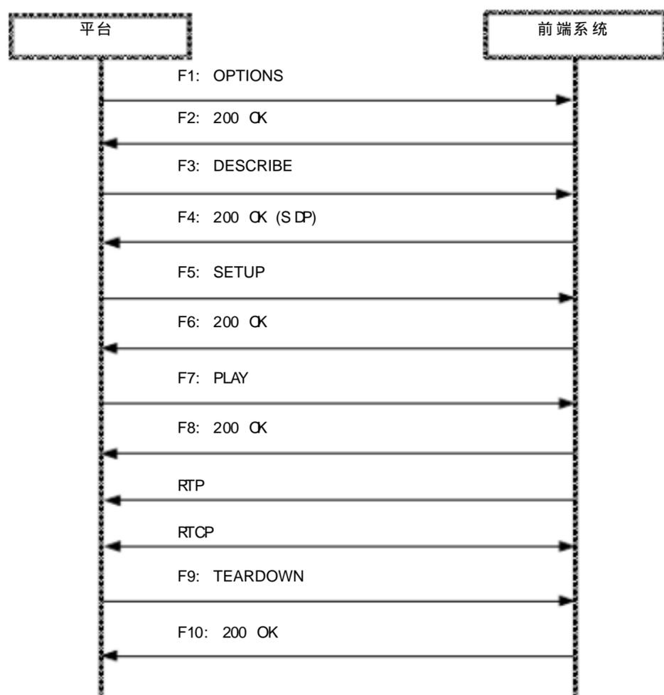
图 B.11 录像回放接口流程
