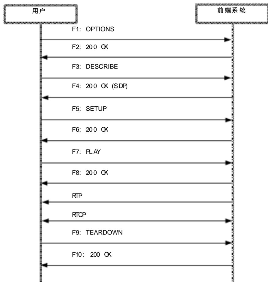
图 C.10 录像回放接口流程
