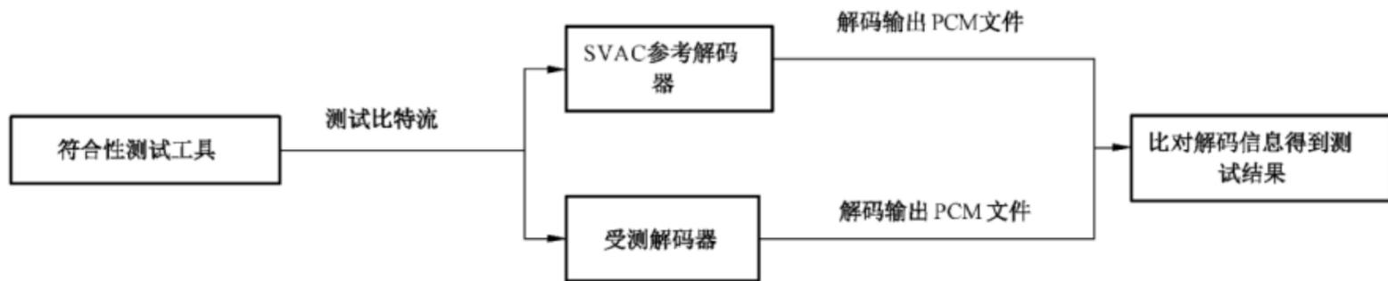
图 8 各档次音频解码器符合性测试流程
