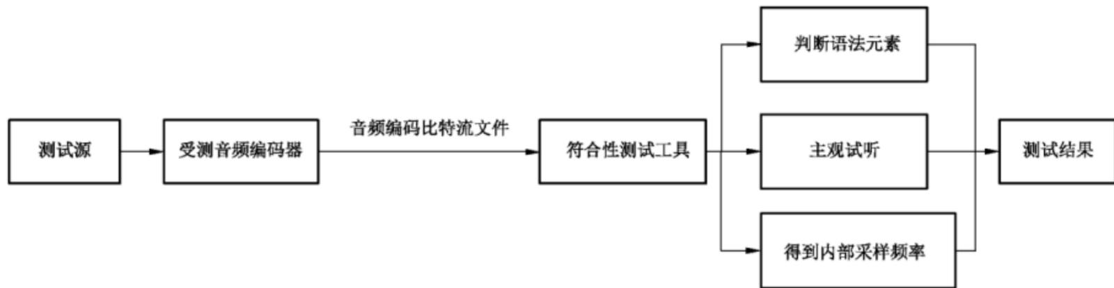
图 7 各级别音频编码器符合性测试流程
