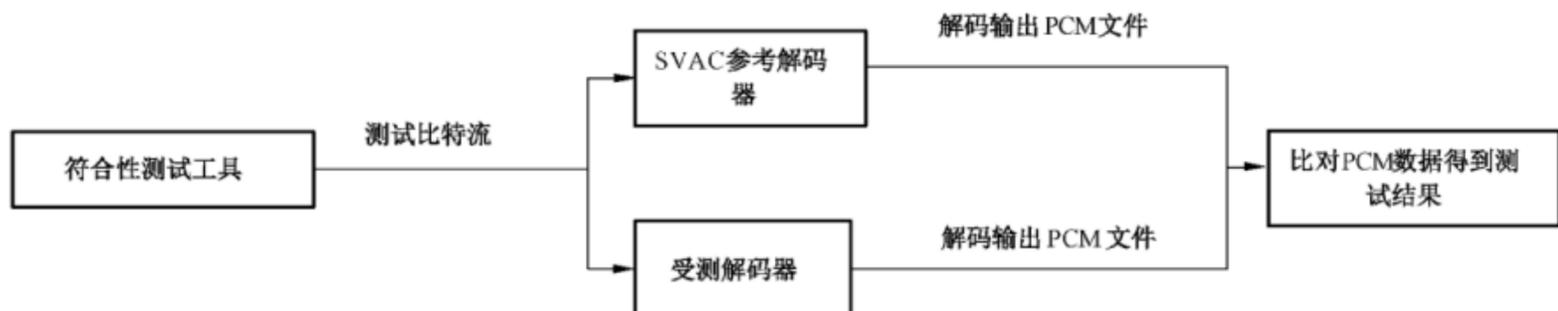
图 9 各级别音频解码器符合性测试流程
